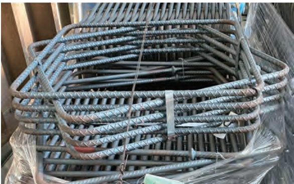
新型電阻銲接閉合型箍筋
