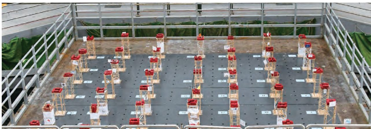
模型安裝於振動台上準備接受考驗
