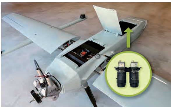
多光譜遙測系統搭載於雲科大自製無人機
