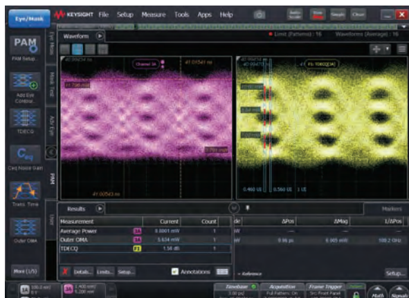
200 Gb/s PAM4 微環調變器量測眼圖，無等化器下顯示清晰開眼
